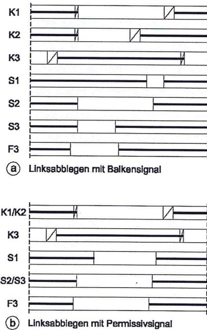
Bild 4: Linksabbiegende Straßenbahn mit Lichtbalkensignal (a) oder mit Permissivsignal (b)
